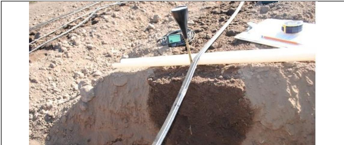
Figura 1216. Avance del humedecimiento en el perfil del suelo en camas de cultivo con un lateral 18 horas después del riego. CEDEH-FHIA, Comayagua 2013.
