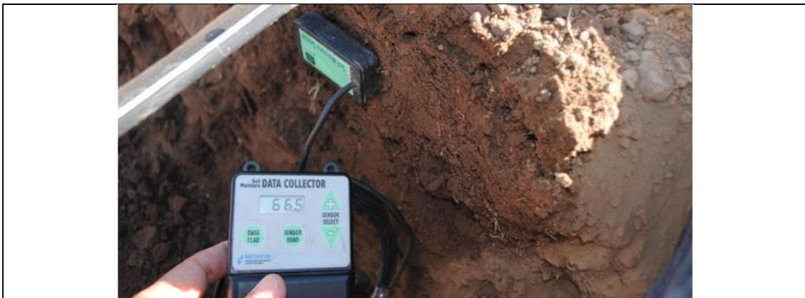
Figura 14. Medición de la humedad del perfil del suelo (0.05 m) con un lateral 18 horas después del riego. CEDEH-FHIA, Comayagua 2013.
